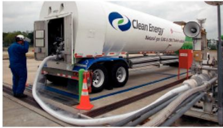
LNG tanker trailer
